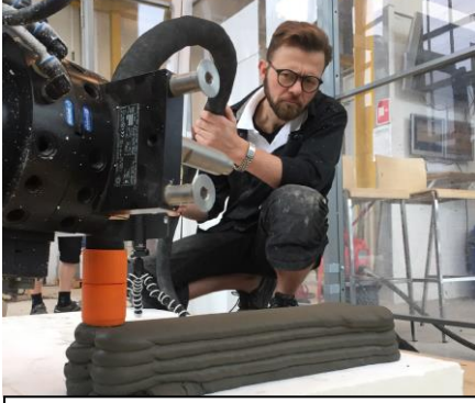
شكل (4) يوضح تقنية الطباعة ثلاثية الأبعاد بمادة الأسمنت حسب التصميم المعماري المحدد. المصدر (5)
