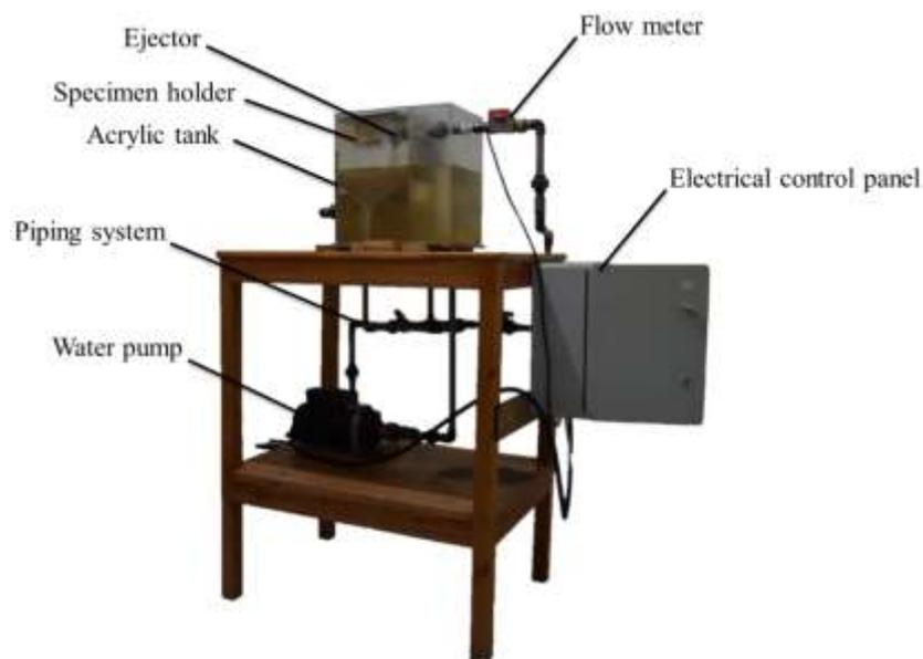
Fig.5 Slurry impingement test rig
