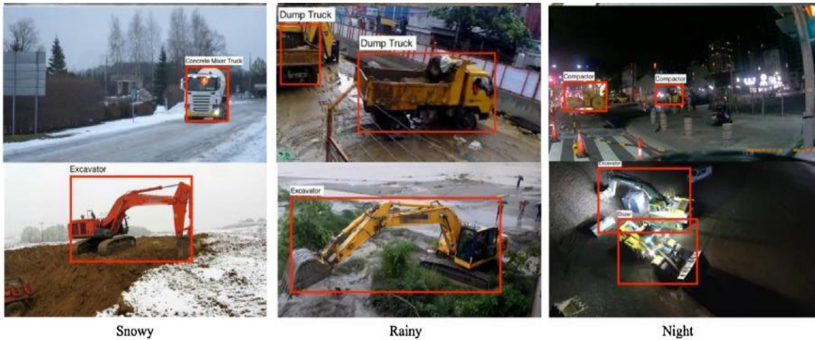
شكل رقم (10) يبين من خلال خوارزميات رؤية الحاسوب يمكن اكتشاف وتعقب المعدات باختلاف البيئات التي تعمل فيها [45]
