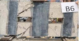
B6-RO-H-F : Diagonal-shear splitting
