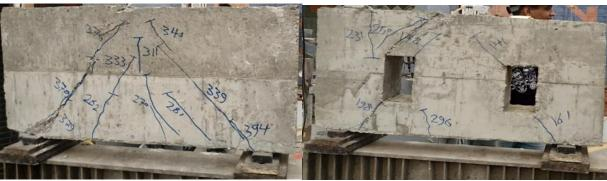
B1: Shear faliure failure
