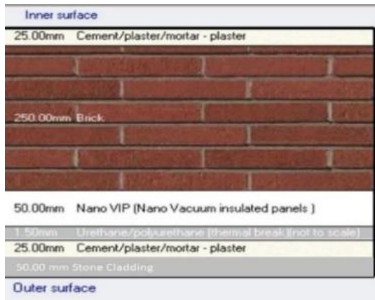
شكل (19) طبقات الحائط بعد استخدام الواح العزل المفرغة - (الباحثة بواسطة برنامج Design Builder)
